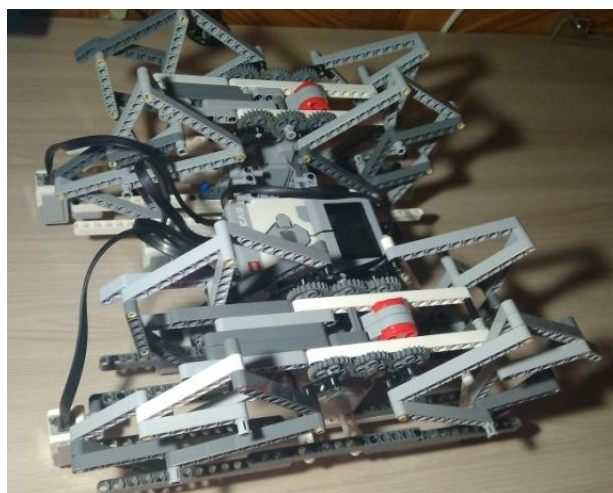
Рисунок 1. Модель робота на основе шагающего механизма Тео Янсена
