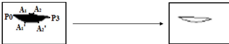
Рис. 4. Результат построения кривых Безье. Справа отмеченные точки для построения. Слева результат построения
