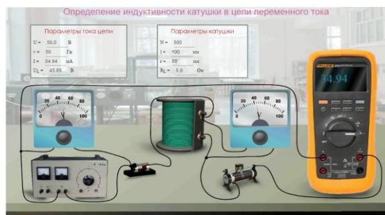
Рисунок 4. Определение индуктивности катушки в цепи переменного тока (составлено автором)
