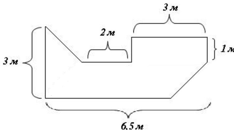
Рисунок 5. Развертка поверхности для покраски
