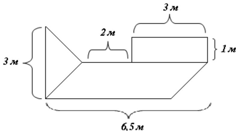
Рисунок 7. Развертка поверхности для покраски, разбитая на треугольник, параллелограмм и прямоугольник
